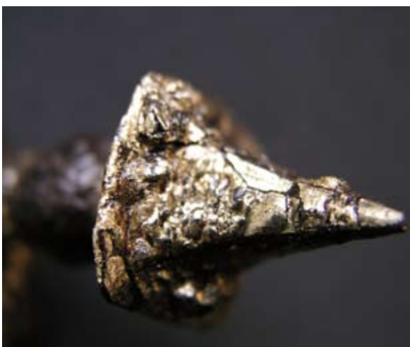
Punta deformada por ampollas y levantamientos
