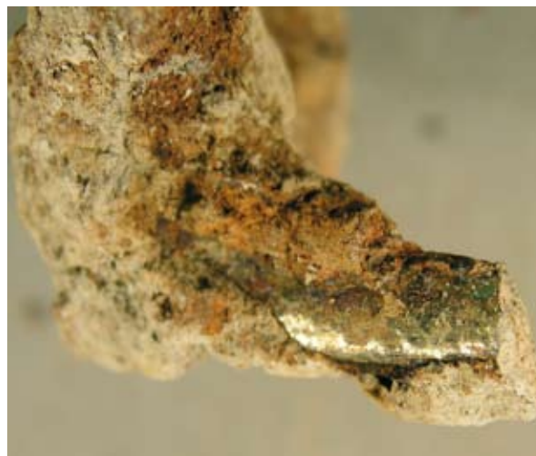
El oro bajo la cobertura de productos de corrosión.
